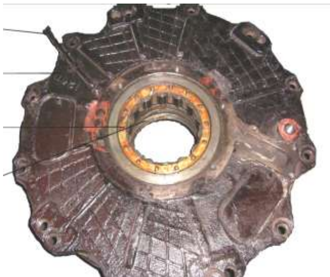
1 – трубка для смазки; 2 – подшипниковый щит; 3 – подшипник; 4 – лабиринтовое уплотнение
