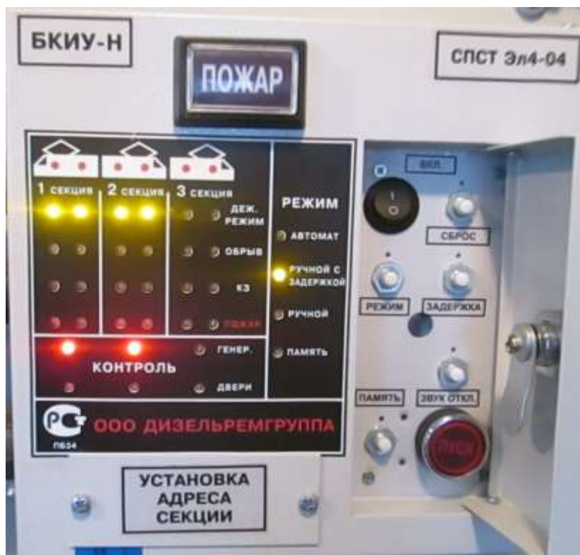
Рис.6.1. Расположение органов управления и элементов индикации БКИУ
