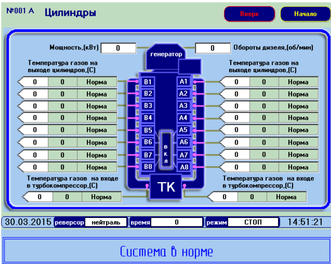
Рис.7.5. Дисплейный модуль (экран «Цилиндры»)
