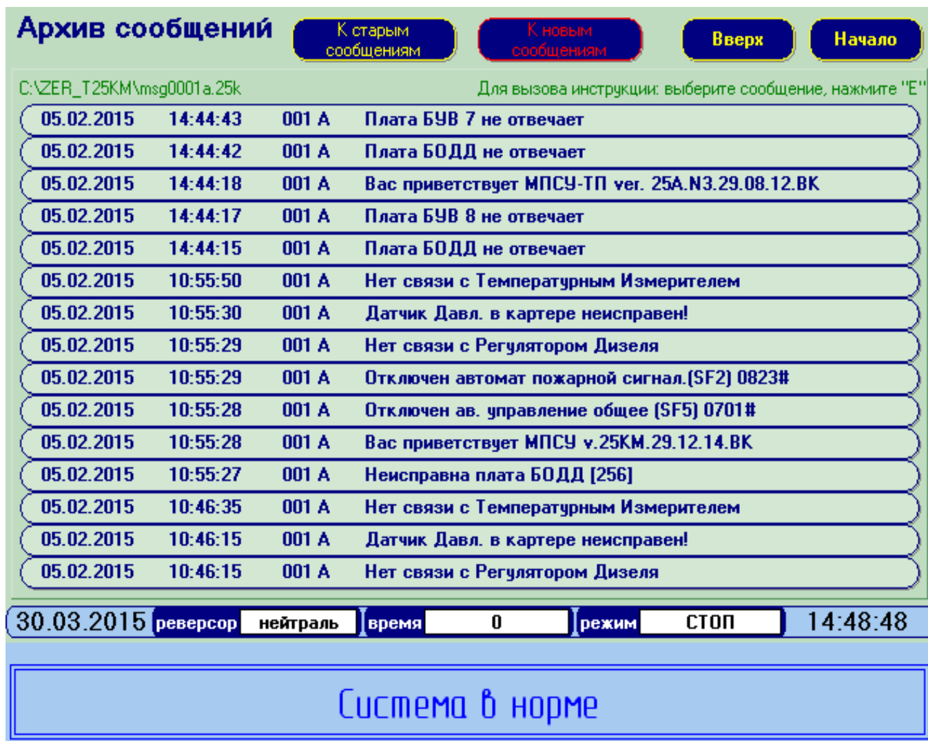
Рис.7.3. Дисплейный модуль (экран «Архив сообщений»)
