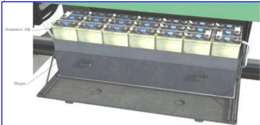
Каждый аккумулятор состоит из стального или пластмассового корпуса, внутри которого находится 2 блока электродов. Один, положительный, имеет 6 пластин, другой, отрицательный, имеет 5 пластин.
